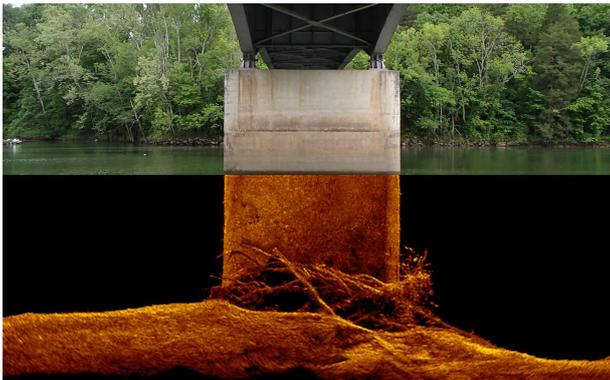
In der Gesamtansicht lassen sich neben Veränderungen am Sediment auch größere Deformationen und Schadstellen am Bauwerk schnell erkennen. Weiter kann die Gesamtansicht mit der Software zu einem 3D Bild umgewandelt werden, um Ingenieuren und anderen Fachkräften eine bessere Visualisierung zu gewährleisten.
